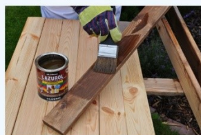
LAZUROL CLASSIC nanášame v 2-3 vrstvách, vždy s časovým odstupom 24 hodín
